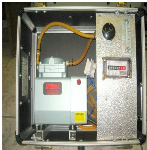
Figura 2: HARVARD, amostrador utilizado na coleta de dados de material particulado, no ano de 2013.
