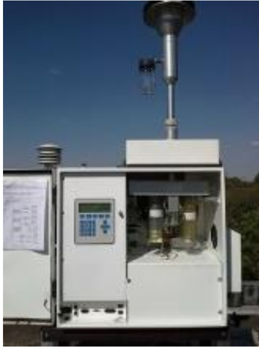
Figura 3: Amostrador contínuo de aerossóis tipo PARTISOL, utilizado na coleta de dados de material particulado, no ano de 2013.
