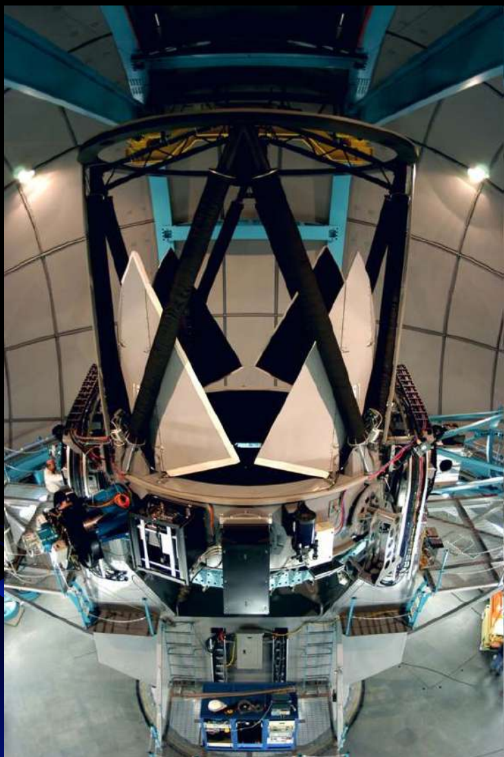
Duas visões do SOAR. Pode-se ver na esquerda a montagem altazimutal e na direita suporte do espelho primário
